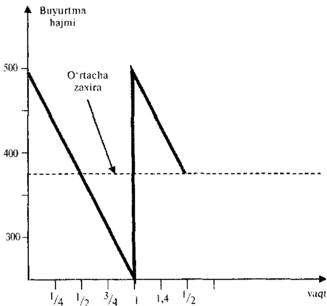
10.4-rasm. Materiallarning ozluksiz ishlatalish sxemasi.  $X=500$  va bir yilda bitta buyurtma berilganda.
