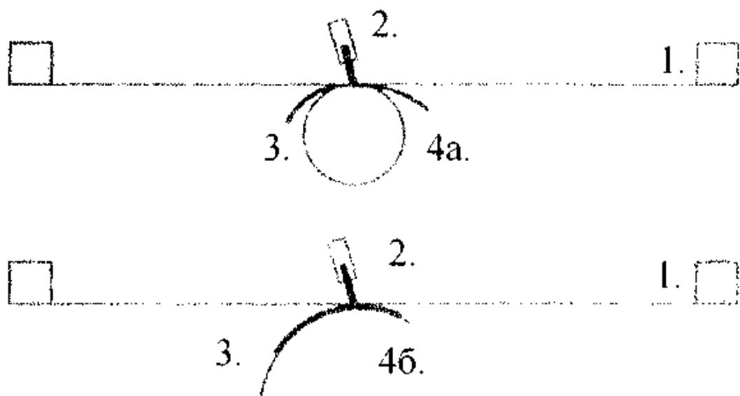
**2.14-Rasm. Trafaret bosma uskunasining ishlash shakli (silindri va segmentli).** 1-bosma rama; 2-stantsionar qo'zg'almas raket; 3-bosma materiali; 4 a-bosma silindri; 4 b-segmentli bosma taglik.
