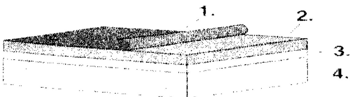
*1.5-Rasm. Fotopolimerlanuvchi qolip plastinasining ko'ndalung kesimi.*
