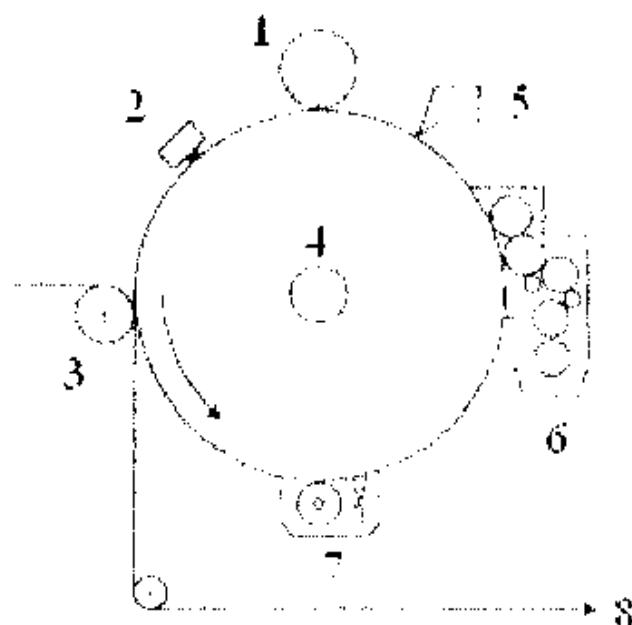
**4.5-rasm. Elkografiya:** 1—yozish qurilmasi (bosuvchi boshcha); 2—chiltirish qurilmasi (rezina pichoq); 3—bosma silindri; 4—metall qoplamiga ega metall silindr; 5—bo'yoq apparati; 6—konditsionerlash qurilmasi; 7—tozalash qurilmasi; 8—bosiluvchi material.
