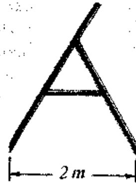
20-rasm. Uzunlik o'lchov asboblari: ruletka va dala sirkuli.
