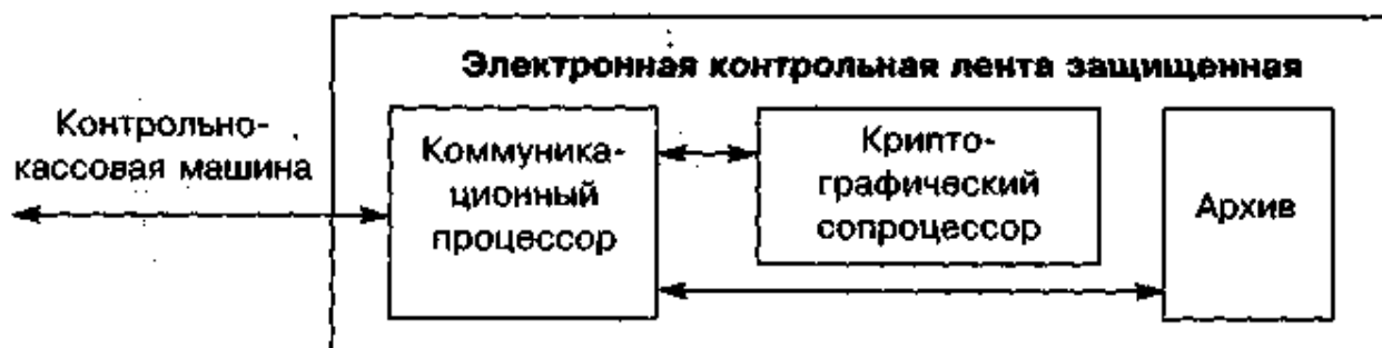
Рис. 2.6. Структурная схема модуля электронной контрольной ленты защищенной
