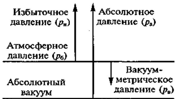
Рис. 3.1. Системы измерения давления
