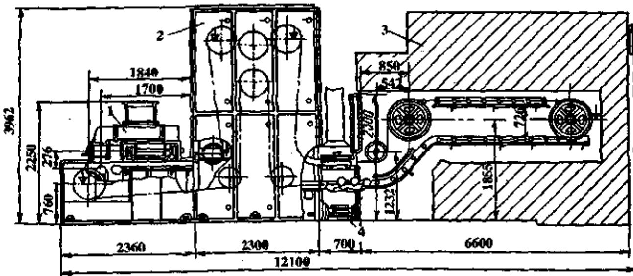
2.7-rasm. Qolipli non ishlab chiqarish uchun P6-XRM tindirish-pishirish agregati:
