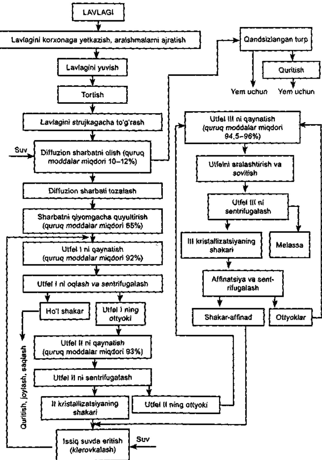
6.2-rasm. Shakar ishlab chiqarish namunavly texnologik sxemasi.
