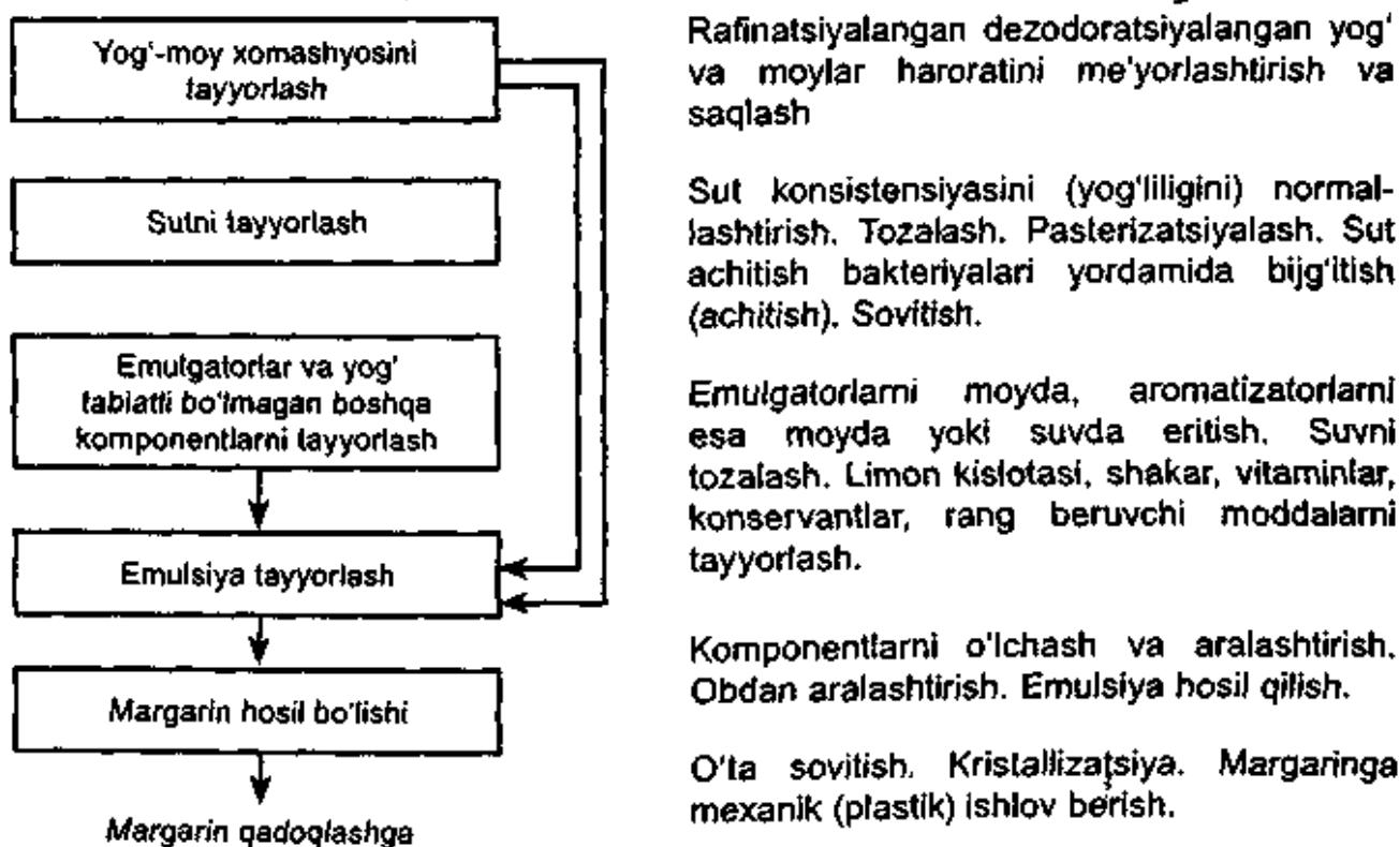
5.28-rasm. Margarin ishlab chigарishning принципиал тeхнологик схемаси.
