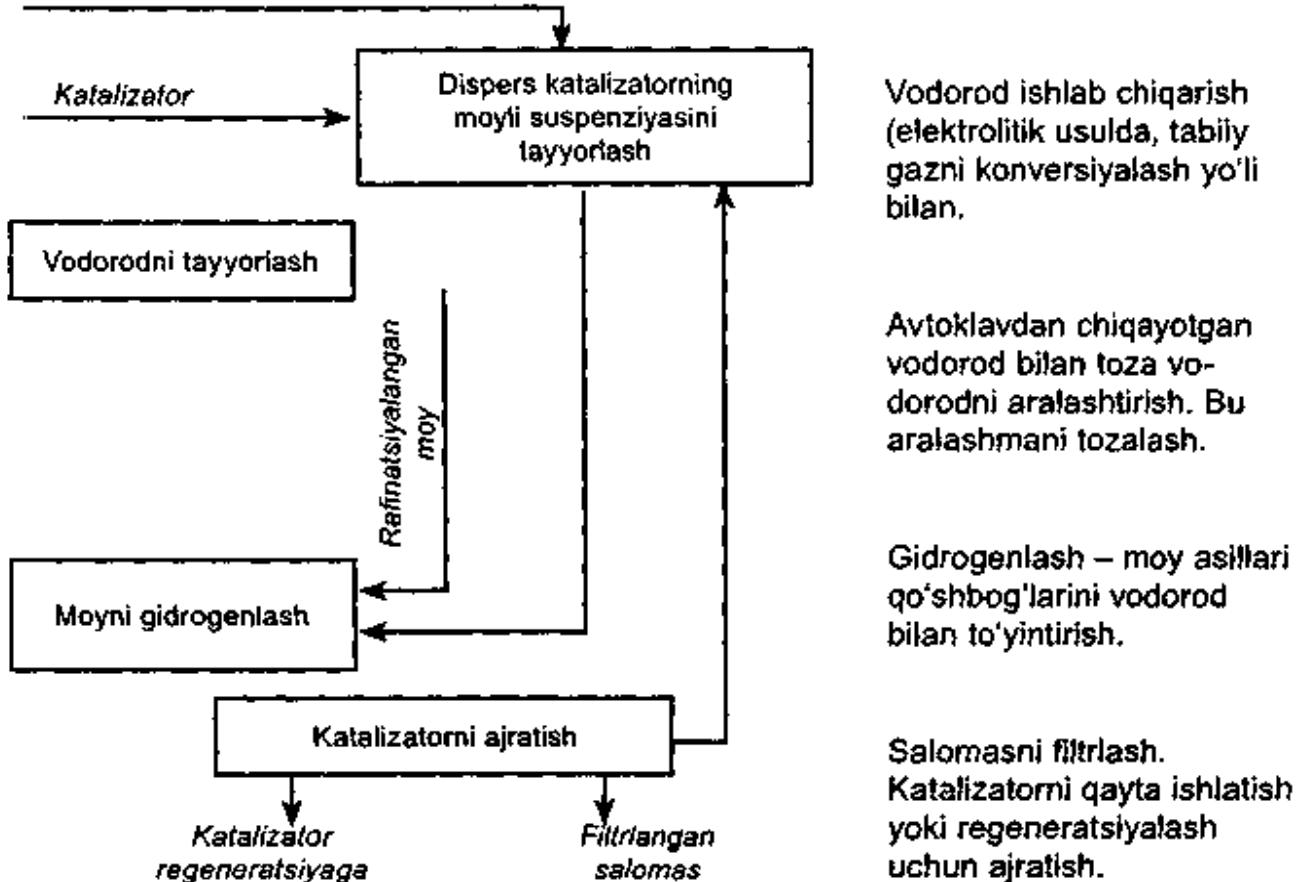
5.24-rasm. Gidrogenlangan yog'lar ishlab chiqarishning prinsipial texnologik sxemasi.
