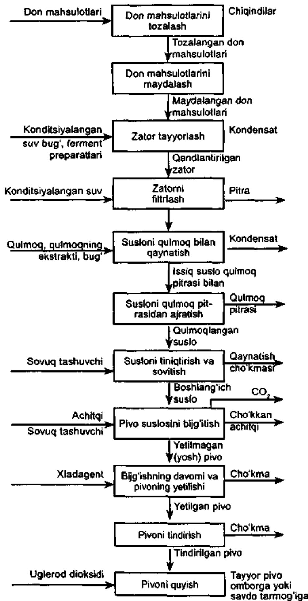
10.1-rasm. Pivo ishlab chiqarishning principial texnologik sxemasi.
