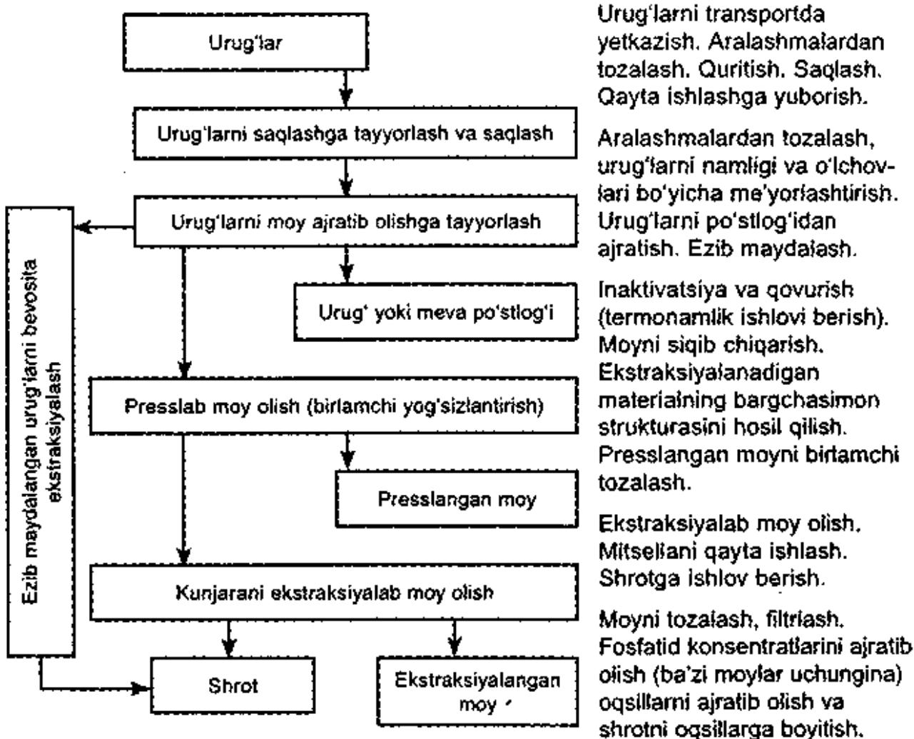
5.1-rasm. O'simlik moylari ishlab chiqarishning asosiy jarayonlari.
