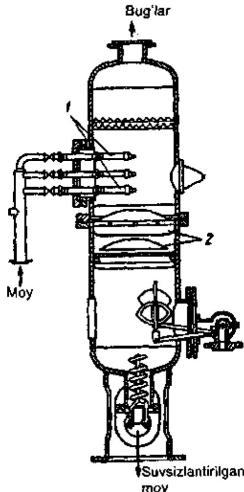
5.19-rasm. Vakuum-quritish apparati.
