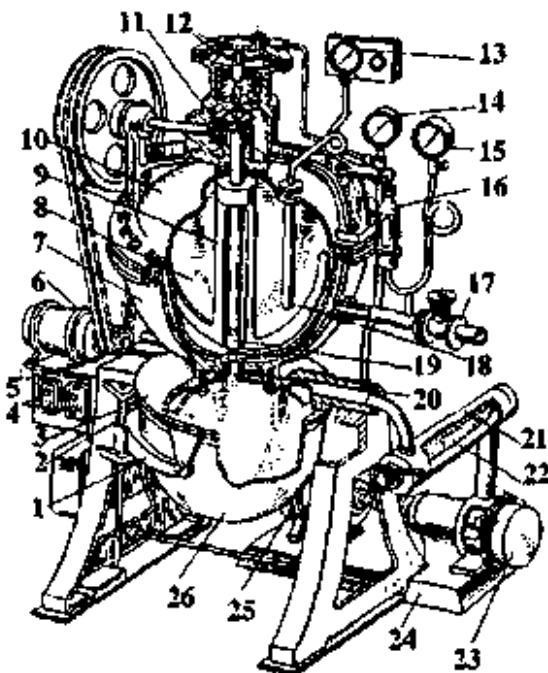
4.3-rasm. Universal qaynatish vakuum-apparati.
