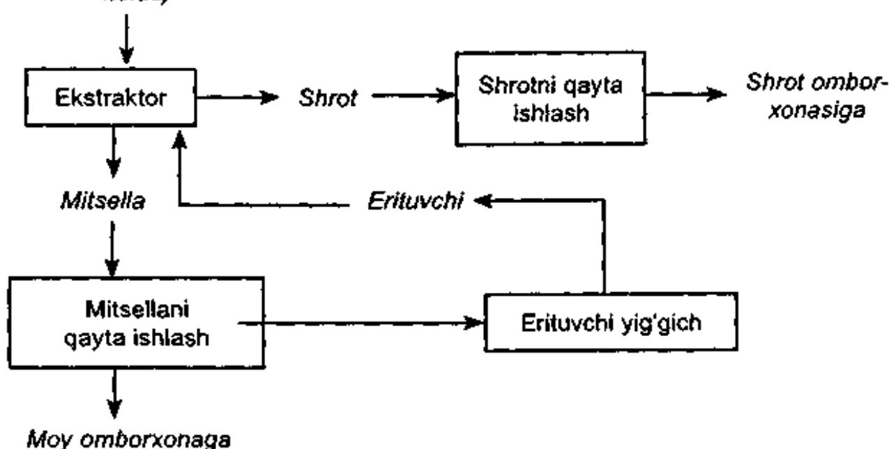
5.9-rasm. Ekstraksion jarayon sxemasi.
