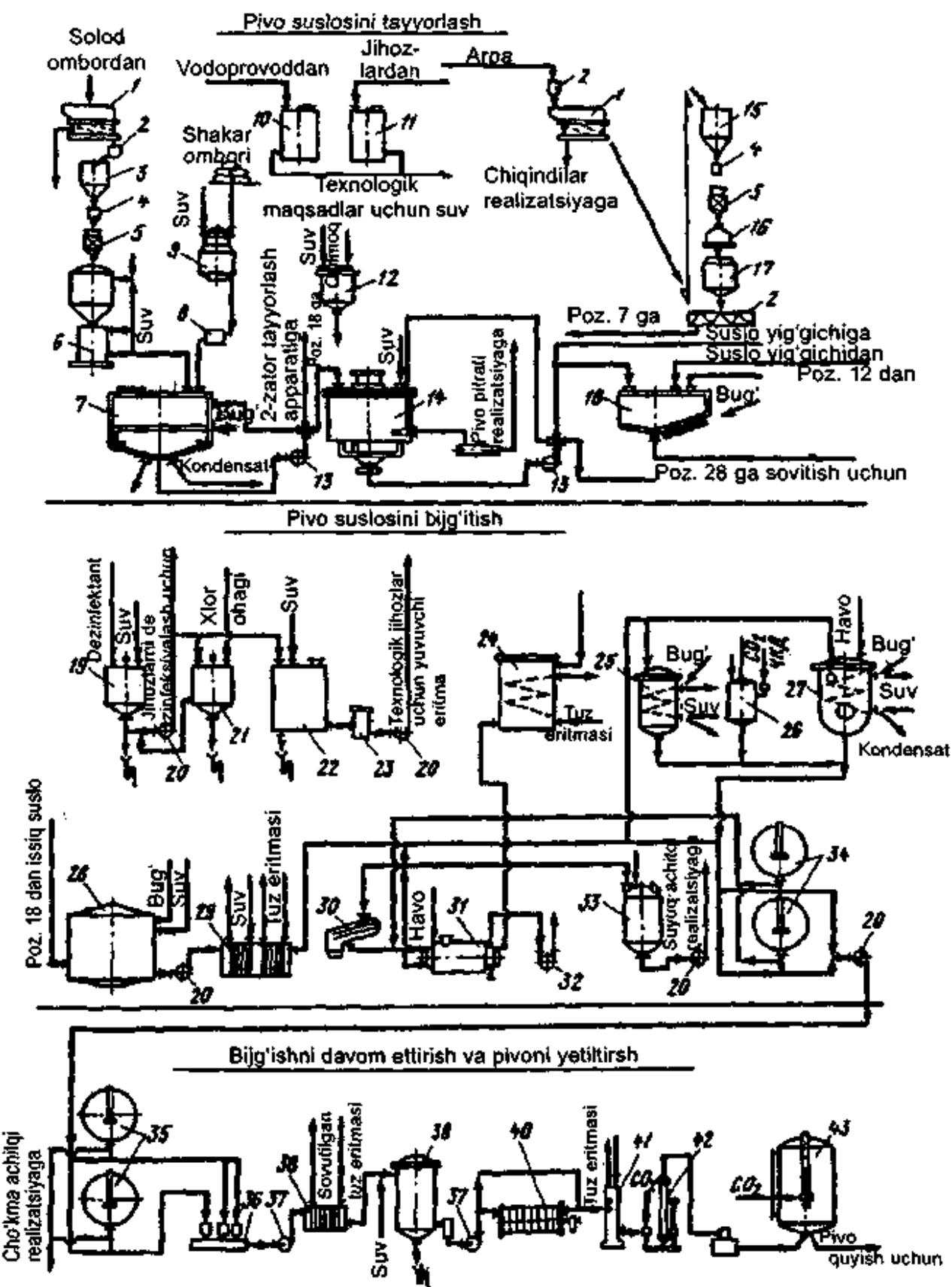
10.2-rasm. Pivo ishlab chiqarishning apparaturaviy-texnologik sxemasi.
