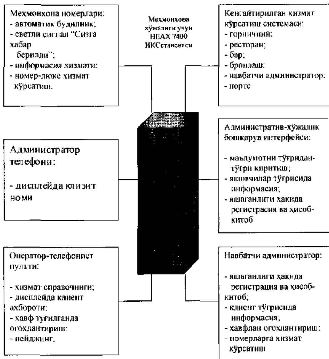
Расм-6.11. Миллиениум HEAX 7400 ИКС мисолида меҳмонхона учун станция схемаси.
