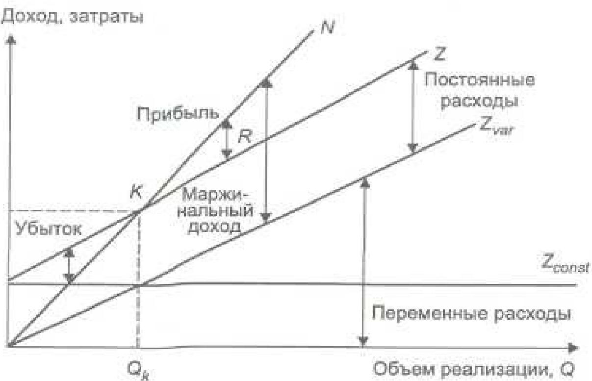
Рис. 4.2. График безубыточности
