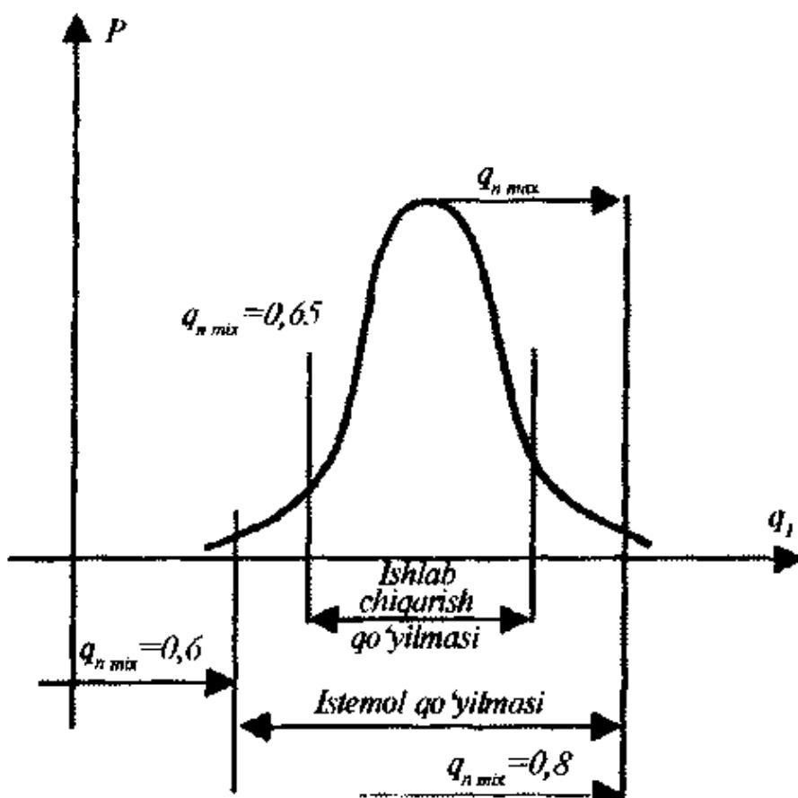
*10.3- rasm. Sifat ko'rsatkichining targalishi diagrammasida ishlab chiqarish va iste'mol qo'yilmalarining munosabati.*
