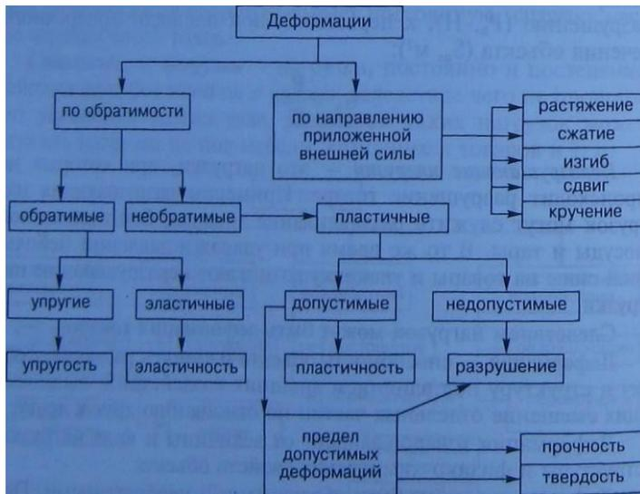
Рис. 22. Классификация деформаций и взаимосвязь со структурно-механическими свойствами
